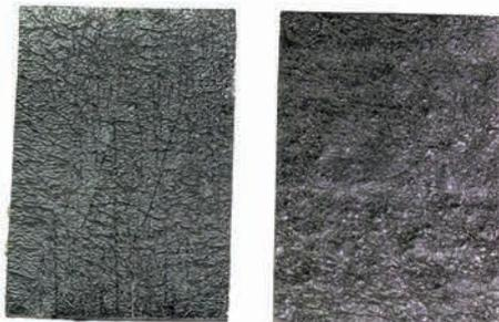
این نوع عایق رطوبتی که قیر آن با مواد لاستیکی بهینه سازی شده است، انعطاف پذیری بسیار خوبی در دماهای زیر صفر دارد. کاربرد این ماده در لایه چینی عایق زیر مخازن سرد می باشد. با تحقیقات انجام شده در شرکت هدکو، امکان تولید این عایق در داخل کشور با کیفیتی بالاتر از مشابه خارجی ایجاد گردیده است. شایان ذکر است که ورود رطوبت به عایق های مخزن عامل اصلی کاهش راندمان و تخریب درازمدت مخزن می باشد.
