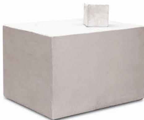
این بتن عایق در زیر پوسته مخازن سرد کاربرد دارد و در مقایسه با سایر بتن ها دارای ضریب هدایت گرمایی پایین تر، دانسیته کمتر و وزن سبک تری می باشد. این نوع بتن در مقابل یخ زدگی و سرمایش متناوب، مقاوم است. در همین راستا تحقیقاتی در شرکت هدکو انجام پذیرفت که نتیجه آن دستیابی به فرمولاسیون بهینه جهت حصول خصوصیات مورد نظر می باشد. در حال حاضر تولید داخلی این محصول آغاز شده و در پروژه های در دست اجرا بکار گرفته شده است.
