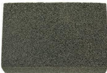
این عایق از ترکیبات شیشه ساز سیلیسی می باشد که با استفاده از عوامل فوم ساز فرآوری شده است. حباب های هوای محبوس در این ماده از آن عایق بسیار خوب حرارتی ساخته است. با همکاری شرکت هدکو تولید داخل این عایق آغاز گردیده است.
